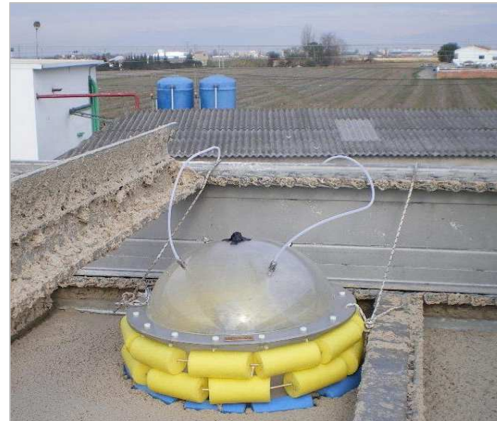
Fuente superficial no aireada Cámara de flujo
