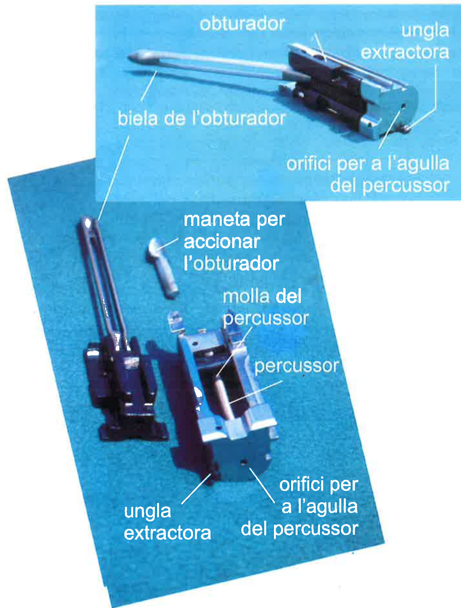
Fig. 1.13. Especejament d'una escopeta semiautomàtica del calibre 12 (sense el canó) i detall del mecanisme de disparador i de percussió
