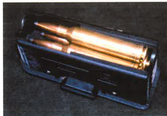
Fig. 1.14. Carregador extraïble d'un rifle de pany, amb capacitat per a tres cartutxos
