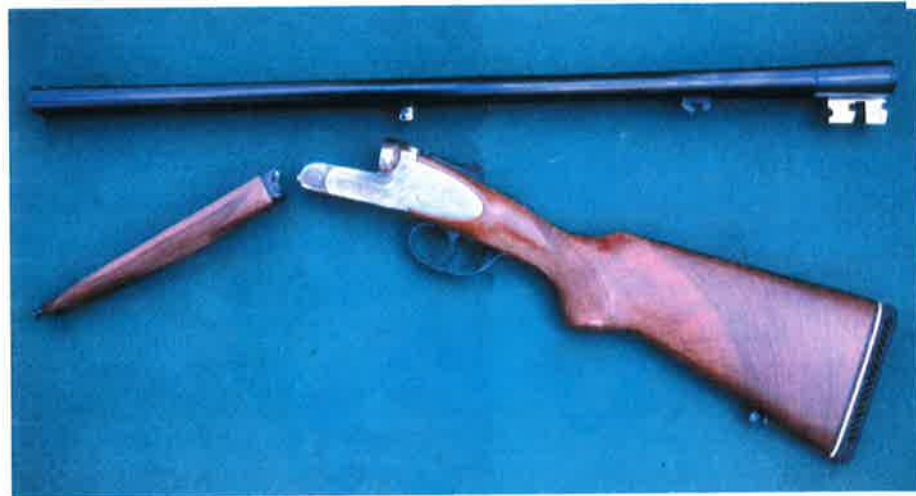
Fig. 1.6. Escopeta plana o juxtaposada del calibre 12
