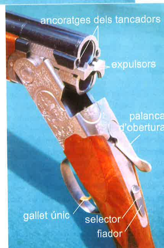
Fig. 1.9. Elements estructurals de la bàscula i part proximal del canó d'una escopeta superposada
