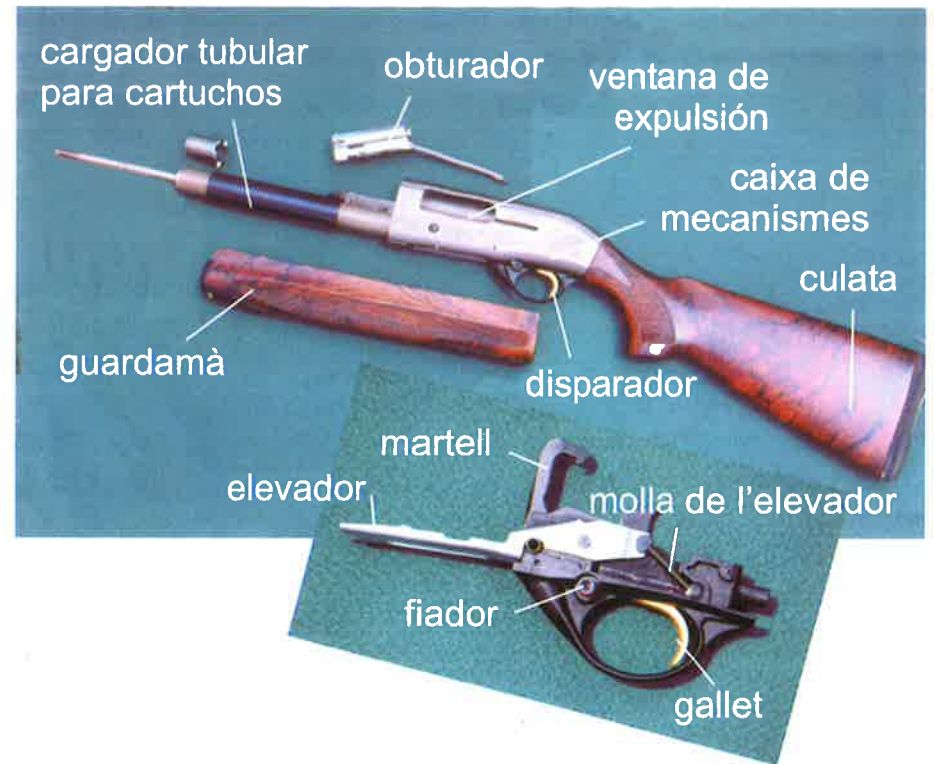
Fig. 1.12. Especejament d'una escopeta semiautomàtica del calibre 12 (sense el canó) i detall del mecanisme de disparar i de percussió
