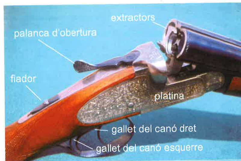
Fig. 1.8. Elements estructurals de la bàscula i part proximal del canó d'una escopeta plana de platina llarga i gallet doble
